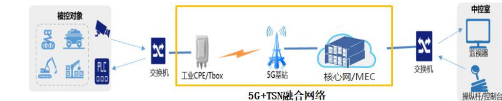
图 16 面向矿山工程机械远程控制的 TSN 与 5G 融合参考架构
