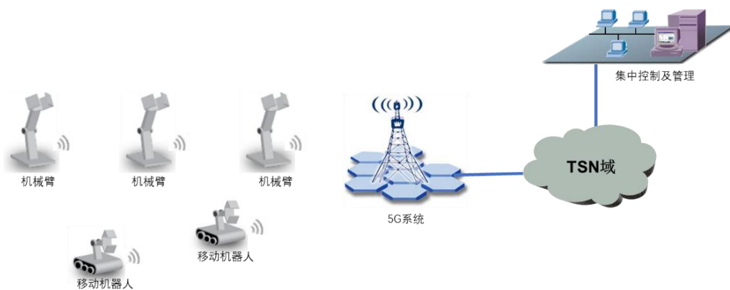
图 8 基于 TSN 和 5G 技术的机械臂、移动机器人
